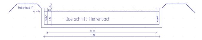
Vertieft man den neuen Kanalboden um 7 cm bleibt der Wasserspiegel gleich. Genauso könnte man den Damm um 7 cm erhöhen um die jetzige Schutzhöhe beizubehalten.
